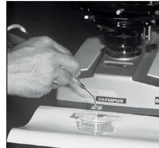
Utilisation la plus appropriée pour la manipulation de composants électroniques tels que pour les circuits intégrés et les intégrations à grande échelle. Utilisation également appropriée pour les petites pièces et les pièces microscopiques, telles que celles des montres et des produits chimiques.
